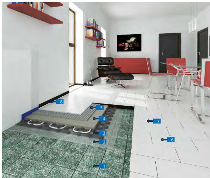
SISTEMA DE COL·LOCACIÓ DE GRES PORCEL·LÀNIC FINS SOBRE SISTEMA DE CALEFACCIÓ RADIANT DE BAIX ESPESSOR
